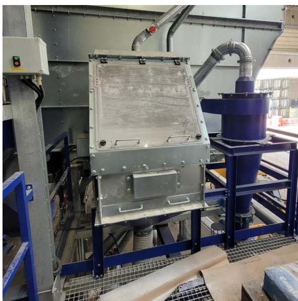
Obrázek 2 Stanice pro dávkování sorbentu do zásobníku
